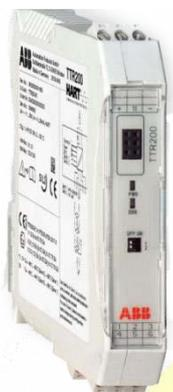
El TTR200 es una versión de montaje en riel del transmisor TTH200 con la adición de dos indicadores LED. Un LED verde indica que el transmisor está encendido. Un LED rojo indicaría una falla en la unidad o en el sensor. Las unidades TTR200 se pueden colocar en bastidores de gabinete y se pueden configurar a través de FDT / DTM en DAT200 (Asset Vision Basic) o cualquier herramienta FTD estándar a través de EDD
