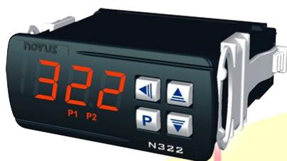
N322 es un controlador de temperatura para calentamiento y refrigeración, con 2 setpoints independientes. El segundo setpoint puede ser relativo al primero, con retardo entre el accionamiento de las fases. Posee 1 relé de 10 A y otro de 3 A, entrada para Pt100, termistor NTC o termocuplas tipo J, K y T con ajuste de offset del sensor.
