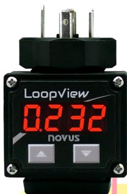
LoopView es un indicador de bucle de 4-20 mA a dos hilos, de bajo consumo. Su excelente precisión permite indicar diversas medidas como presión, presión diferencial, caudal, pH, temperatura, aceleración y otras. Dispone de conector tipo válvula estándar EN 175301-803 (antigua DIN 43650 forma A) macho y hembra.
